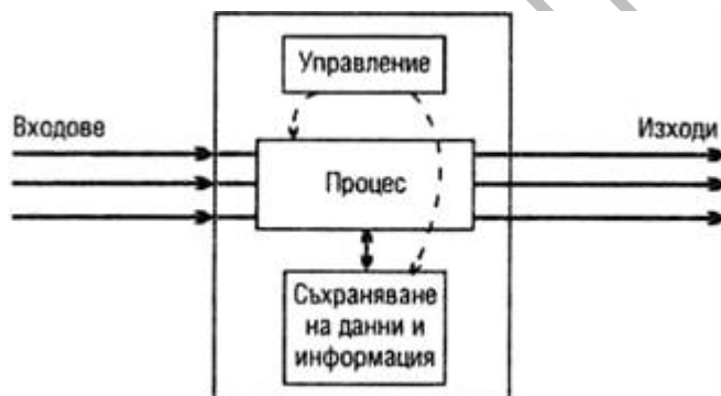
Фиг.1.3 Обобщен модел на система
